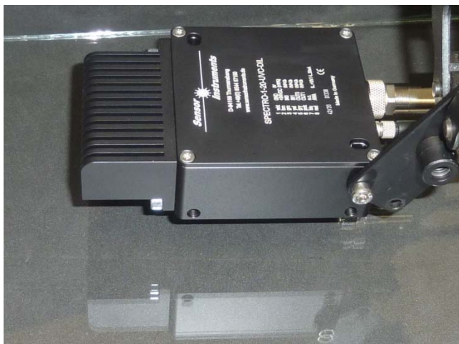
Układ sensoryczny SPECTRO-1-20-UVC-DIL skierowany na stronę cynowaną szkła typu float
