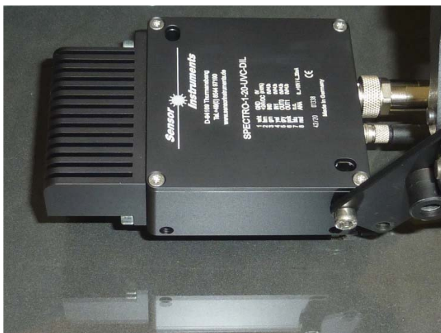
Układ sensoryczny SPECTRO-1-20-UVC-DIL skierowany na stronę ogniową szkła typu float z odległości 20 mm
